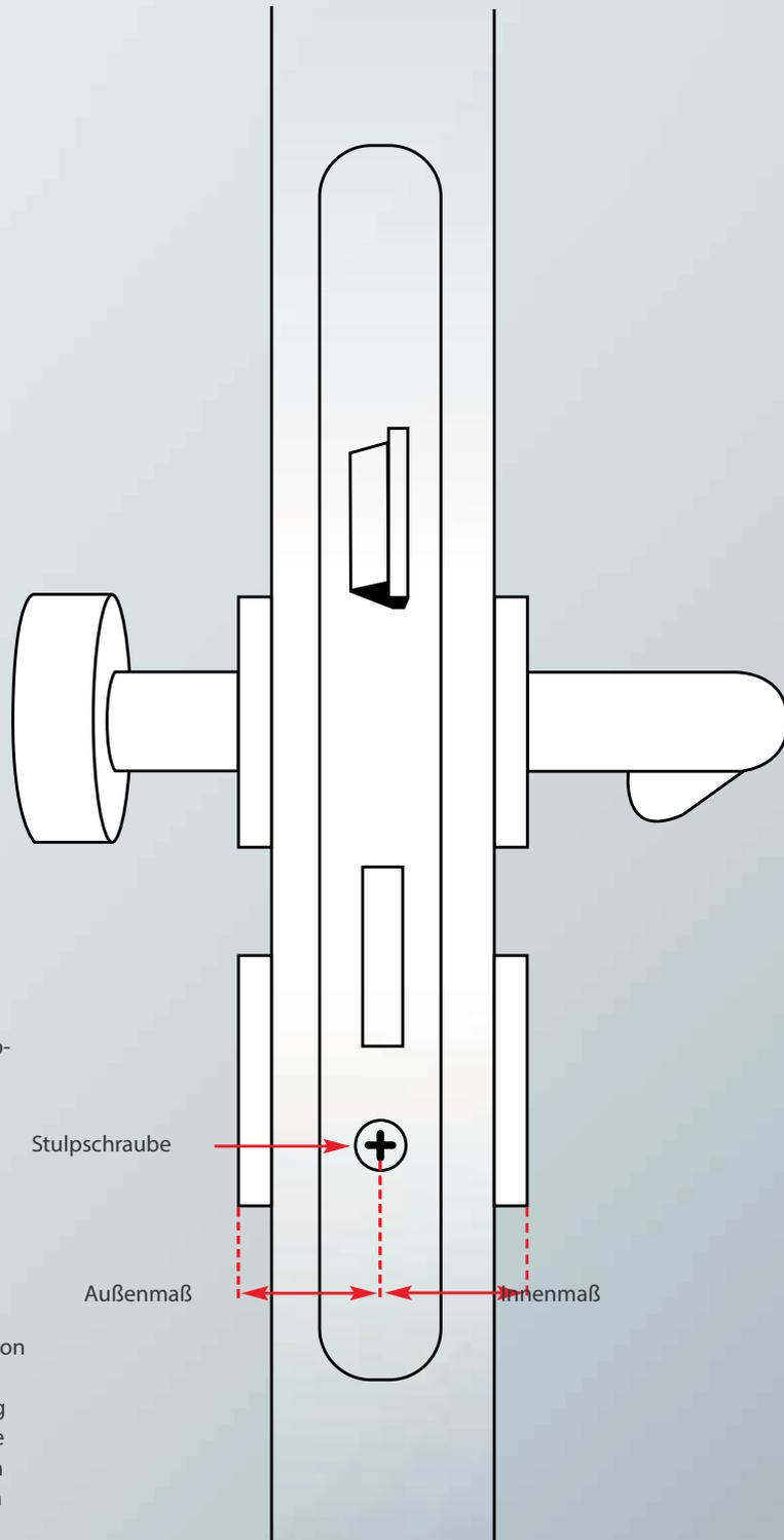
Bevor der Schließzylinder bestellt wird, muss zunächst die benötigte Zylindergröße ausgemessen werden. Benötigt wird ein Außen- und ein Innenmaß. Gemessen wird mit dem Zollstock oder einer Messschablone von Mitte der Stulpschraube bis zum Ende der Abdeckung.
